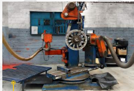
RASPA MANUAL máquina tradicional utilizada pela maioria das recapadoras.
