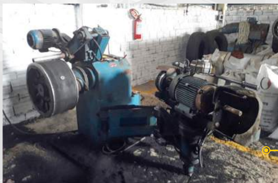
RASPA TIPO “LAMBRETA” muito utilizada em pequenos reformadores e “fundos de quintal”.
