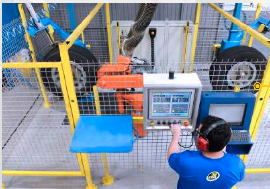
RASPA ROBÔ (automatizada) sem interferência do operador. Uma das tecnologias encontradas em indústrias de reforma como a FM Pneus.
